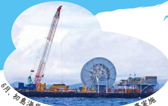
6月、初島海底送配水管 海底部分布設替工事実施
