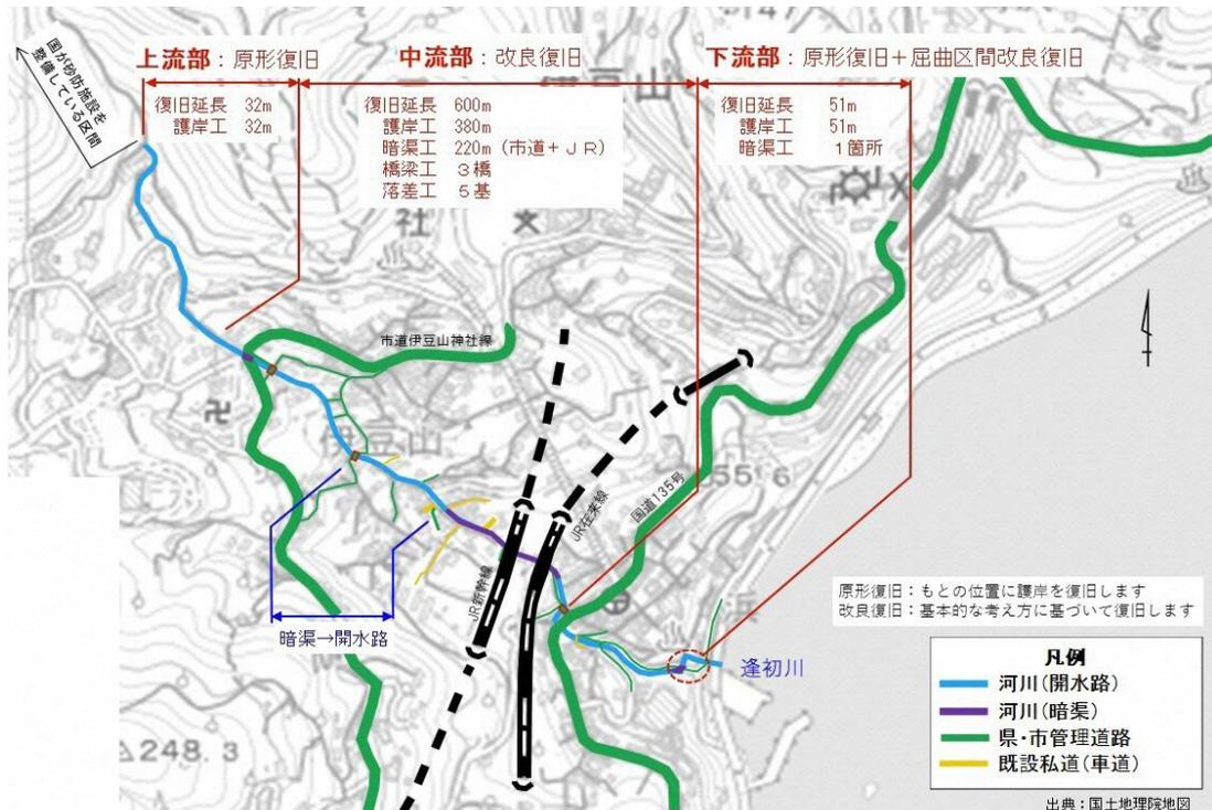
図 逢初川の河川改修の計画図
