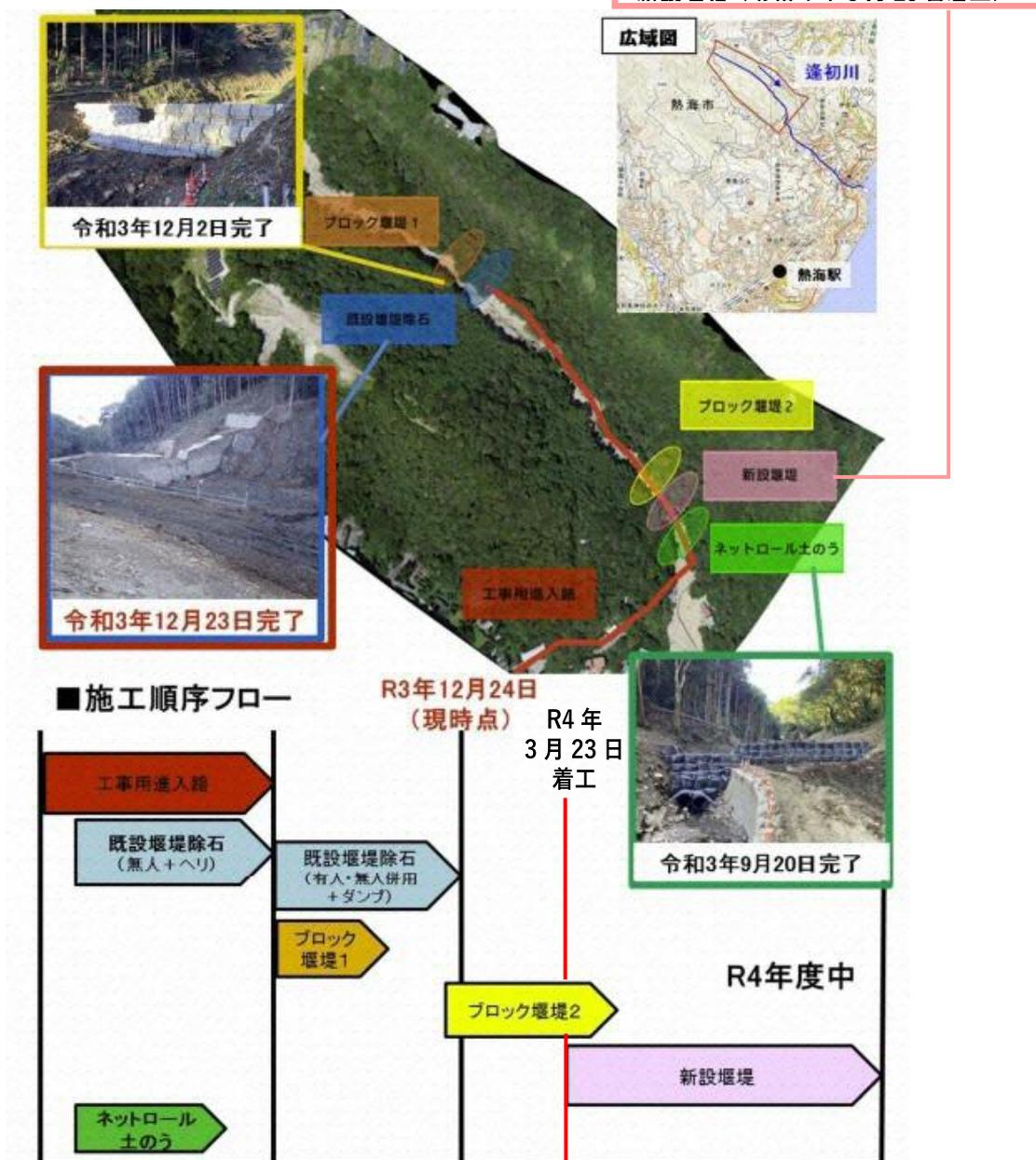
図 国土交通省による砂防堰堤の整備（出典：国土交通省富士砂防事務所 HP）
