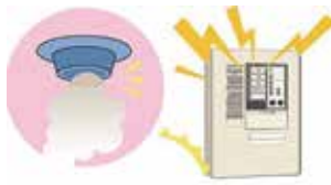
自動火災報知設備 (火災の早期発見に有効)
