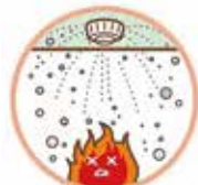
スプリンクラー設備 (初期消火に有効)
