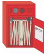
屋内消火栓設備 (初期消火に有効)
