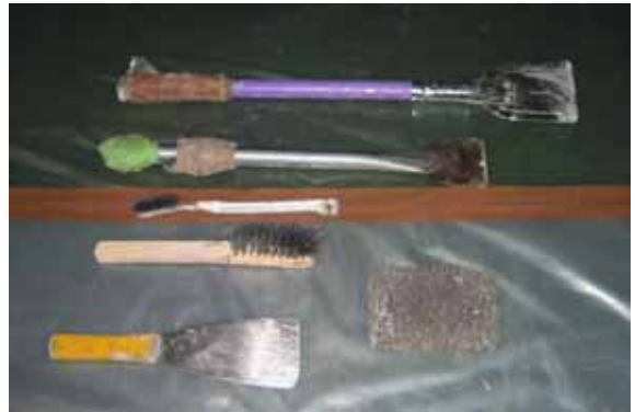
図表 3-72 除去作業用の手工具の例
